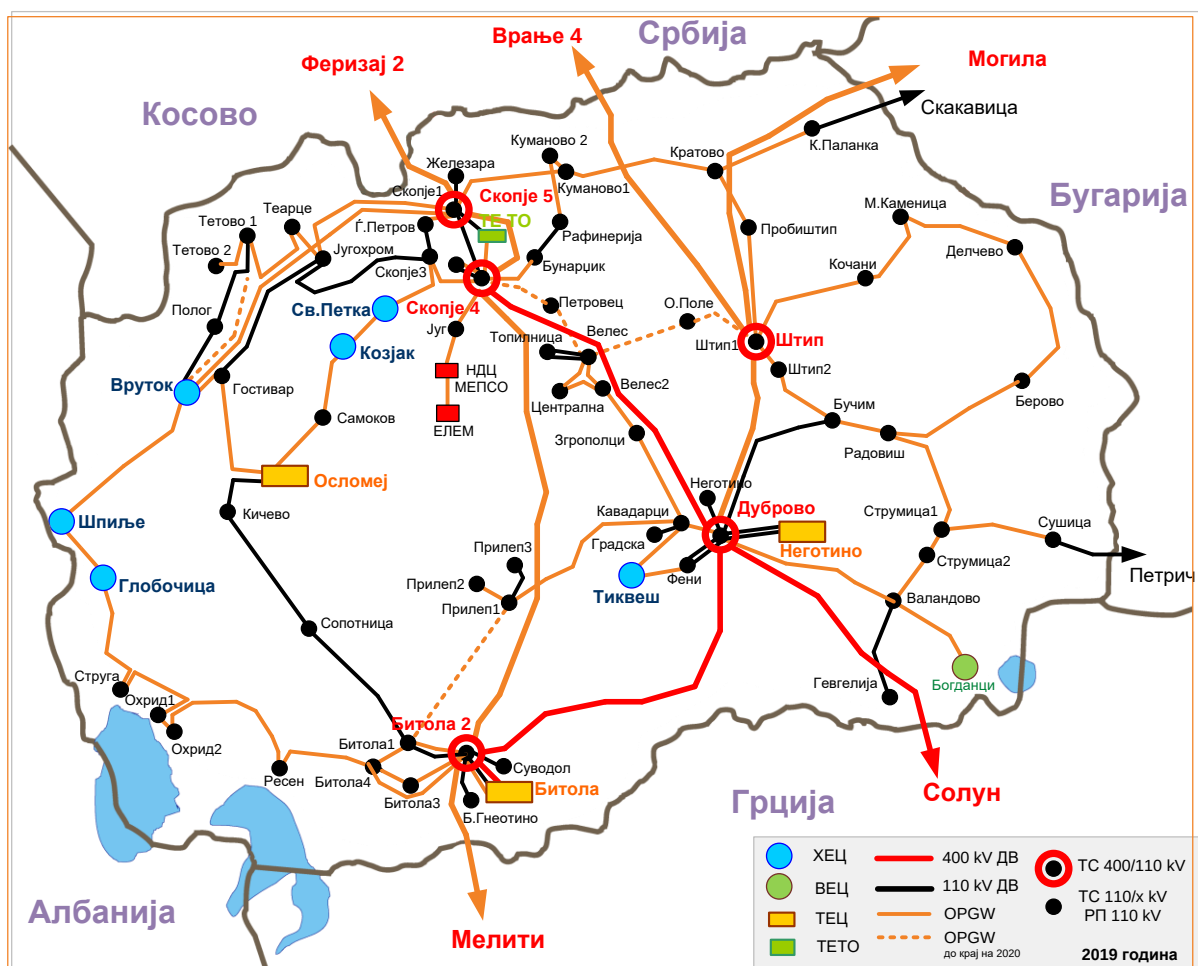
Слика 12. OPGW заштитно јаже по далекуводите на преносната мрежа
